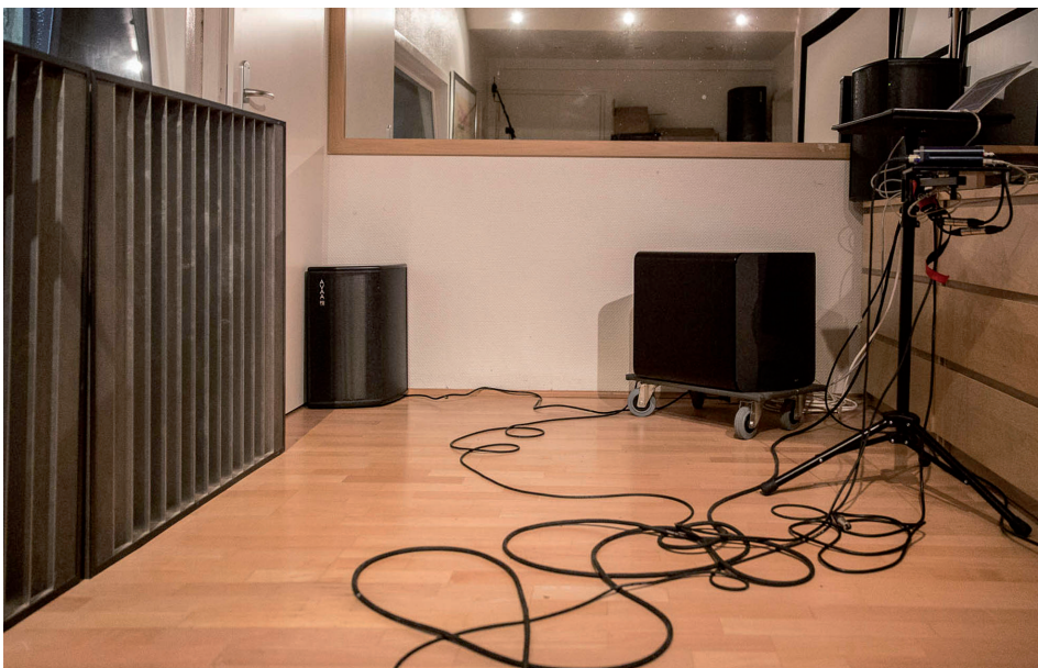
Messaufbau in einem leeren, unbehandelten Raum mit den Ergebnissen aus Abbildung 7
