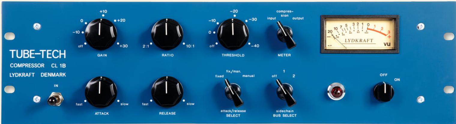
Das Original: Der Lydkraft Tube-Tech CL 1B ist ein Opto-Kompressor mit integriertem Röhrenverstärker. Zu seinen Eigenheiten zählen zwei separat aufgebaute Zeit-Schaltkreise, die sich per Wahlschalter einzeln oder in Kombination einsetzen lassen und einen großen Spielraum für vielgestaltige Klangformung bieten.
