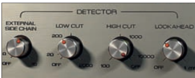
Mit der Detector-Schaltung des FET Compressors kann das Steuersignal des Regelwegs vielfältig bearbeitet werden
