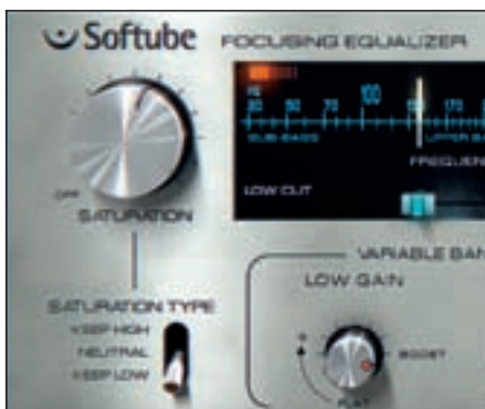
Der Focusing Equalizer besitzt einen Saturation-Regler zur Beimischung von Sättigungsverzerrungen.
